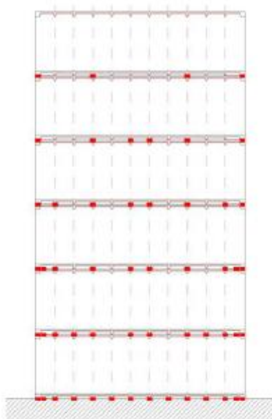
Figura A5.1: Ejemplo de distribución de puntos de apoyo en un edificio.
